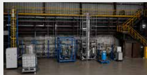
Démonstrateur LLT de captage de CO 2 , d'une capacité de 50 kg/h. © LLT.
