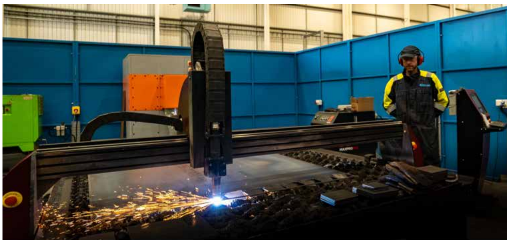
Opérateur Boccard UK utilisant une machine de découpe laser / plasma haute définition.
