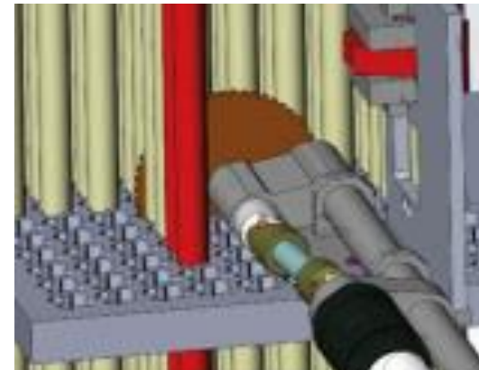
Une scie à refendre les plaques tubulaires
