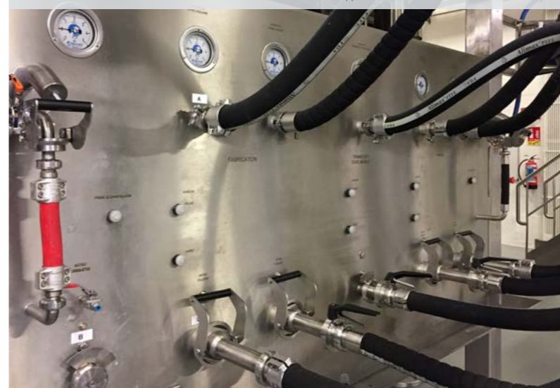
Панель перекачки для внесения сырья и отбора проб с безразборной мойкой гибких шлангов и мобильных соединений
