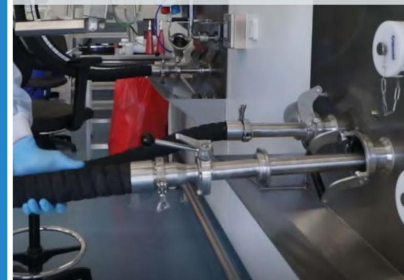
Boclock с ручкой на стороне панели перекачки для соединения всасывающего патрубка (обратный BocLock)
