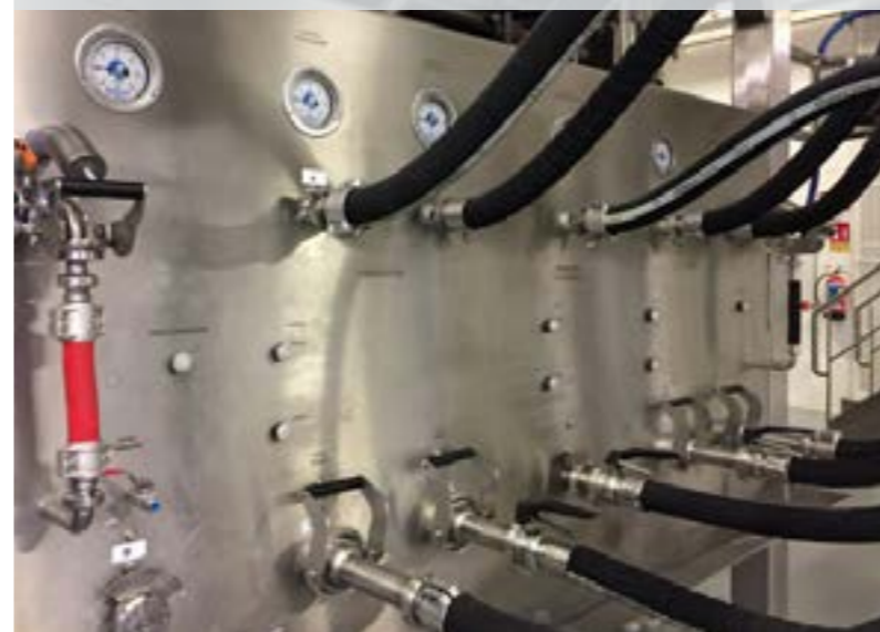
Panel transferowy do wprowadzania i pobierania surowca z miejscowym myciem węży i lanc
